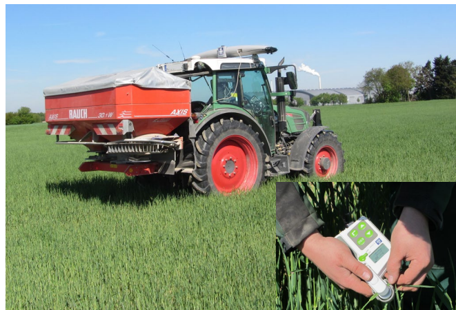
Yara N-Sensor mit Düngemittelstreuer und N-Tester zum Kalibrieren des Sensors
